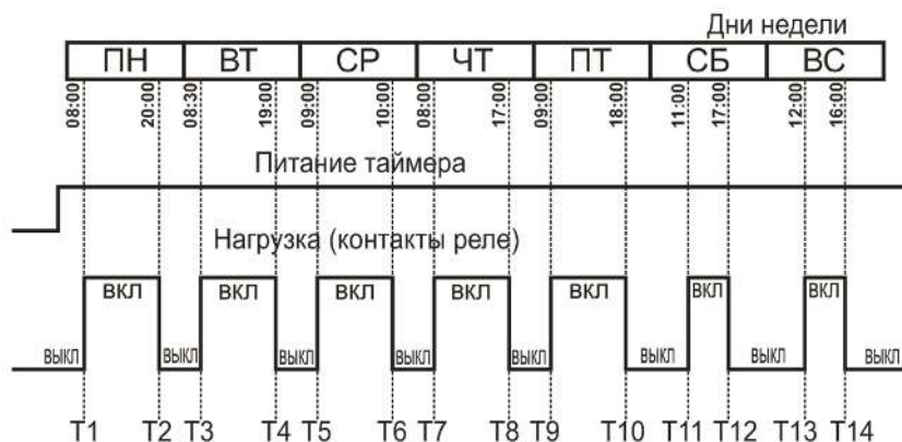
Рисунок 3.4 – Включение нагрузки на примере недельного режима работы
